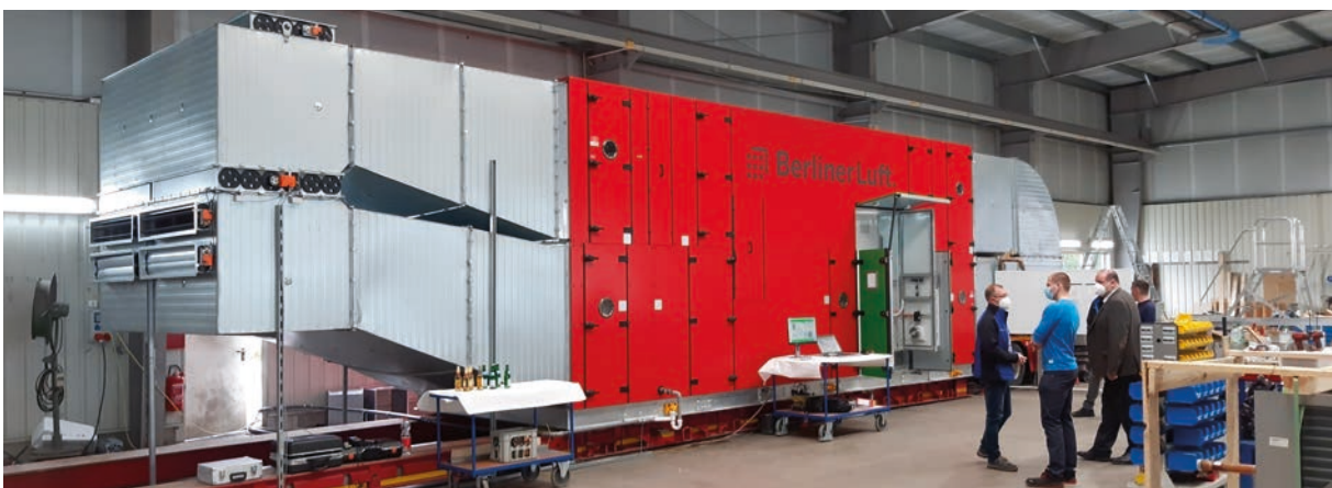
Die Abbildung zeigt die von BerlinerLuft konstruierte Testeinrichtung zur Erstellung eines geforderten Leistungsnachweises. Es gibt im Markt kein Testlabor, das Klimageräte mit indirekter Verdunstungskühlung in dieser Leistungsgröße testen kann.
